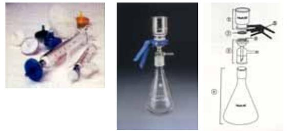
液体积较大或颗粒物较多可以先用较粗滤膜过滤，再精细过滤。流动相存在不溶颗粒物会堵塞管道和柱子，磨损泵头、阀门；样品或流动相不经脱气处理容易产生气泡，影响流速的精确性、柱子的分辨率、检测器检测结果的准确性和稳定性。
