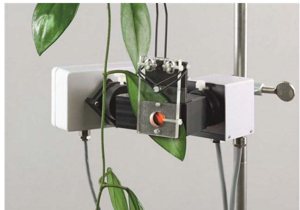
叶片状样品测量用特制叶夹
