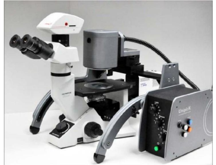
该系统以脉冲负压为动力，毛细管为采集工具，可以和大部分倒置显微镜兼容，根据细胞的形态，位置或荧光标记，从贴壁细胞培养快速而有效地分离特异性细胞，也可以从悬浮细胞培养采集单细胞和从三维细胞培养采集单个多细胞团。
